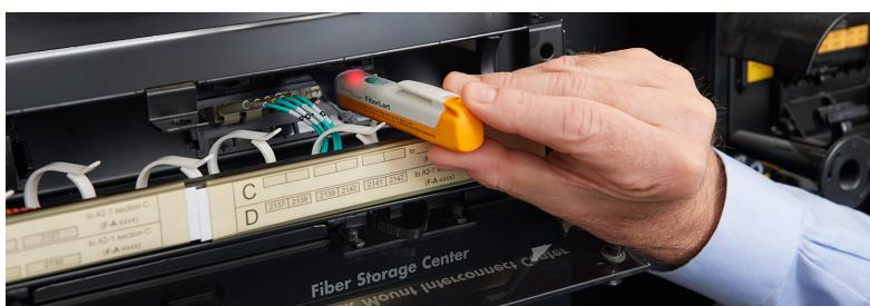
Определение активности портов. Компактный размер устройства облегчает доступ к плотно расположенным портам оптических панелей.
