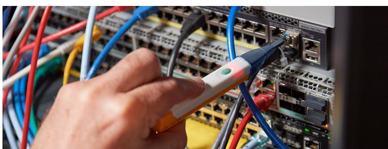
Проверка работоспособности трансиверов. Устройство FiberLert бесконтактно обнаруживает оптические сигналы в линии.
